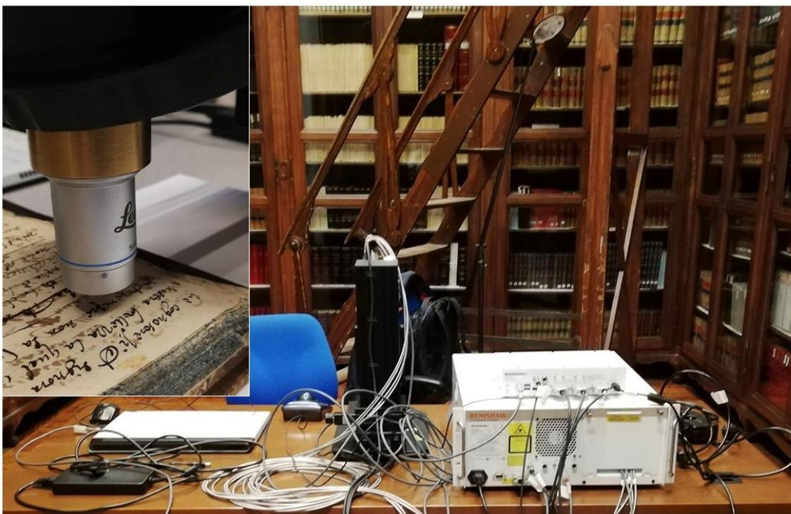
*Ilustración 5: Espectrofotómetro Raman Renishaw Virsa empleado en la realización de este trabajo, instalado en una sala de la Biblioteca del Palacio Real de Madrid. Arriba: detalle del análisis realizado con el microscopio Raman sobre el manuscrito.*
