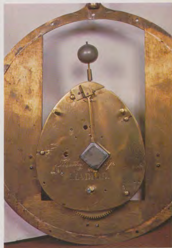
Péndulo con esfera y máquina alojadas en su lenteja, del artífice Abraham Matthey. A la derecha, arriba, un detalle de la suspensión construida por Woolls. Abajo, la máquina de tipo «regulador», con platinas ovaladas (Palacio Real de Madrid).
