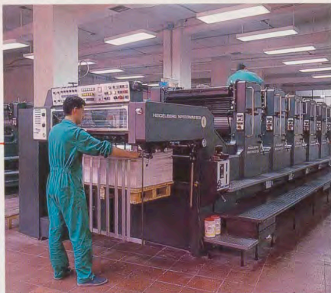
La actual impresión de «Reales Sitios» se lleva a cabo en una Heidelberg offset de seis colores.
