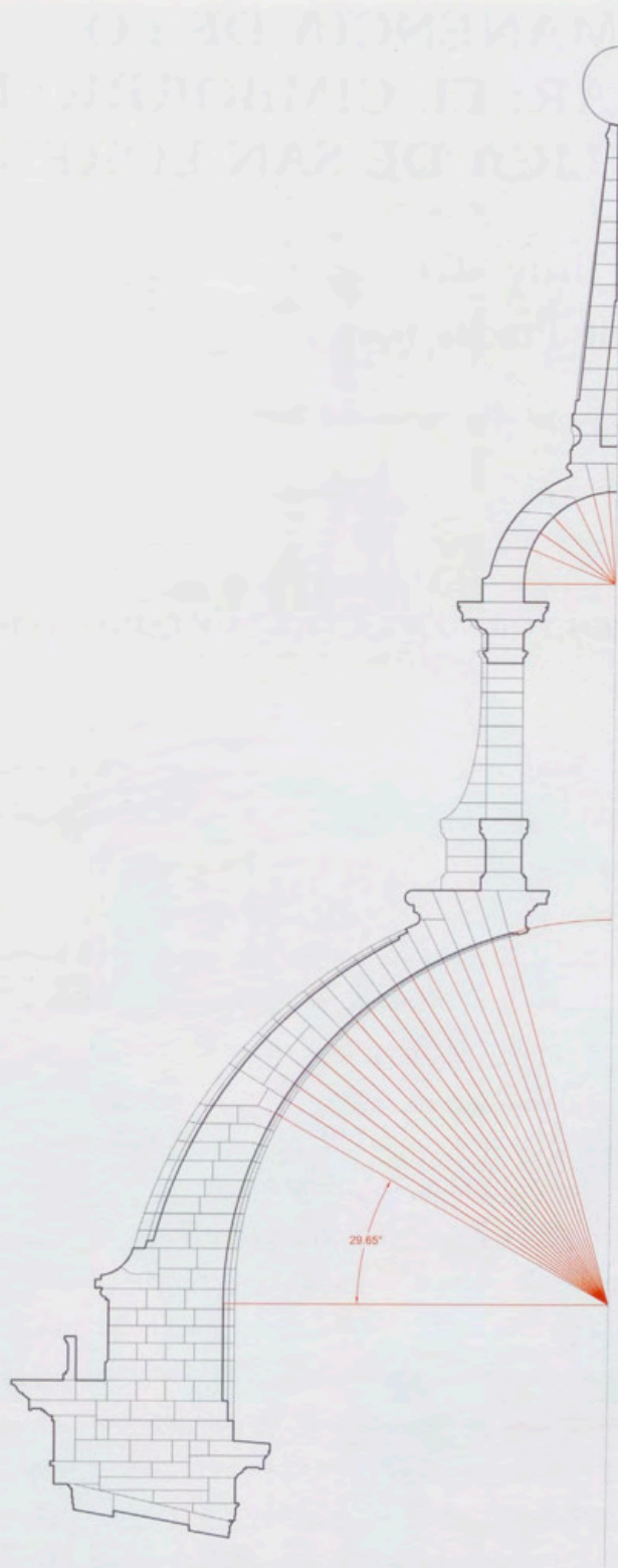
Fig. 17. Propuesta de configuración constructiva de la media naranja de la cúpula y su linterna.
