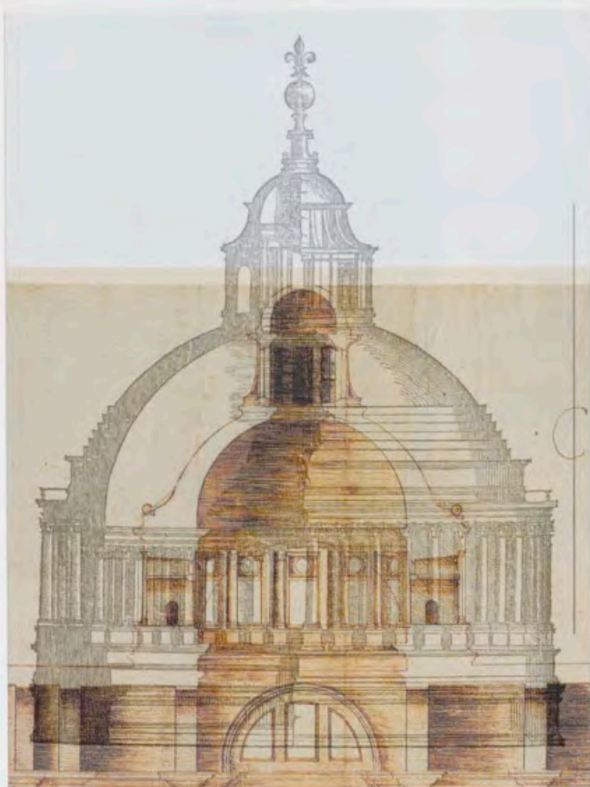
Fig. 4. Comparación entre las cúpulas de la Sección C y del proyecto de Bramante para San Pedro de Roma, según Serlio: a la izquierda, a la misma escala; a la derecha, comparación de proporciones haciendo coincidir centro y radio de las esferas de intradós.
